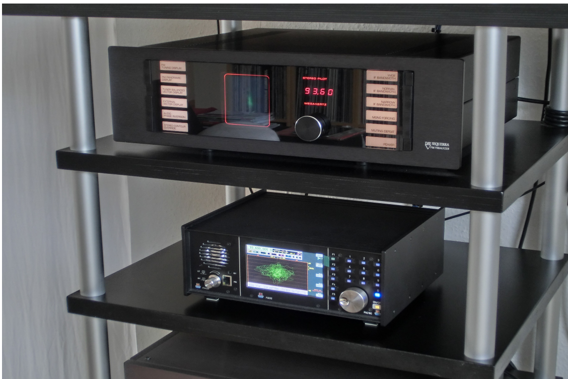
Abb. 12: Day Sequerra Reference Panalyzer und RDR54 im Goniogramm-Modus
