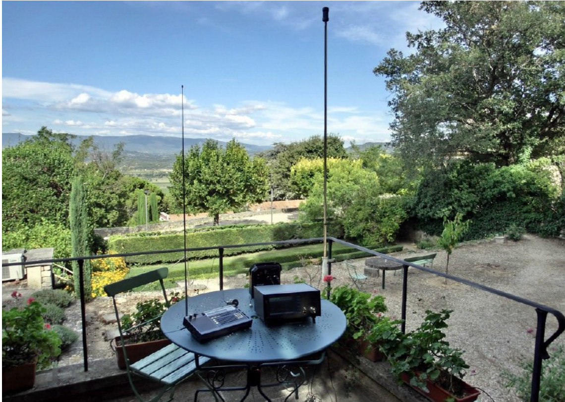
Abb. 19: Set-Up für Portabelbetrieb, RDR50C, Mini-Whip und SONY 2001D als Spotter
